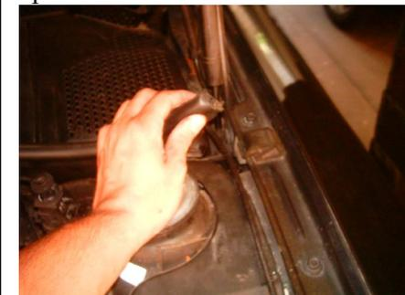
A Válvula de Controle do ar Condicionado é disposto ao lado do filtro do ar condicionado. Abaixo é mostrado o esquema das mangueiras.
