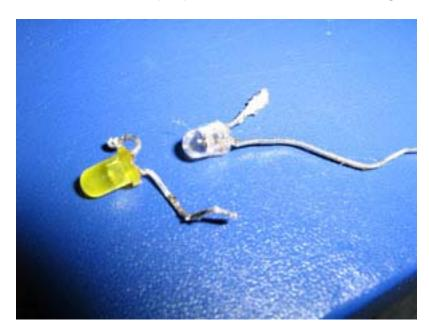
O led original funciona a 12V, e a maioria dos leds que compramos para colocar no carro são de 3V, ou seja, vamos ter que "socar" um resistor ali dentro.
