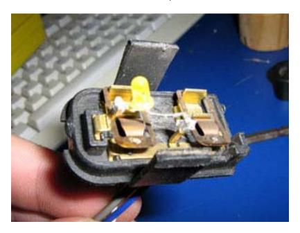
Com um ferro de solda, tire o led original e prepare o novo.
