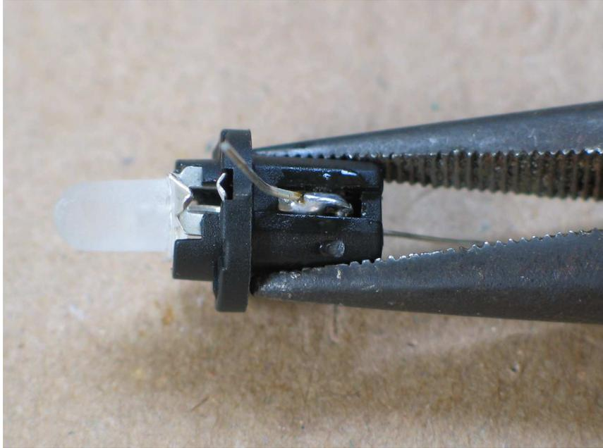
17 – Solde os terminais do LED e do resistor nas travas metálicas.
