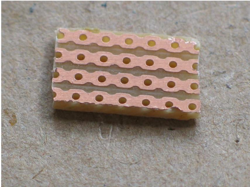
21 – Será necessário unir duas linhas das ilhas de cobre para solucionar uma possível falta de contato no soquete. Uma das linhas centrais deve ser interrompida logo acima da solda.
