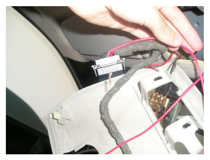
Com a ajuda de uma chave de fenda pequena coloque o pedaço de fio que estava sobrando dentro desses buracos que tem no plugue. Eles não são usados pra nada. Quando você reencaixar o plugue, esse fio fará o contato com o motor, então arrume-o de forma a melhorar a passagem de corrente. Cuidado para que o fio não fique encostando em outro do plugue.
