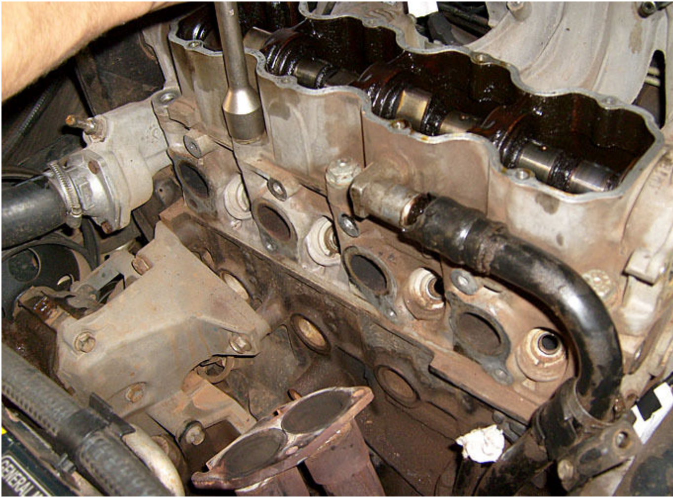
Vista dos tuchos e balancins, após remoção da gaiola do comando:
