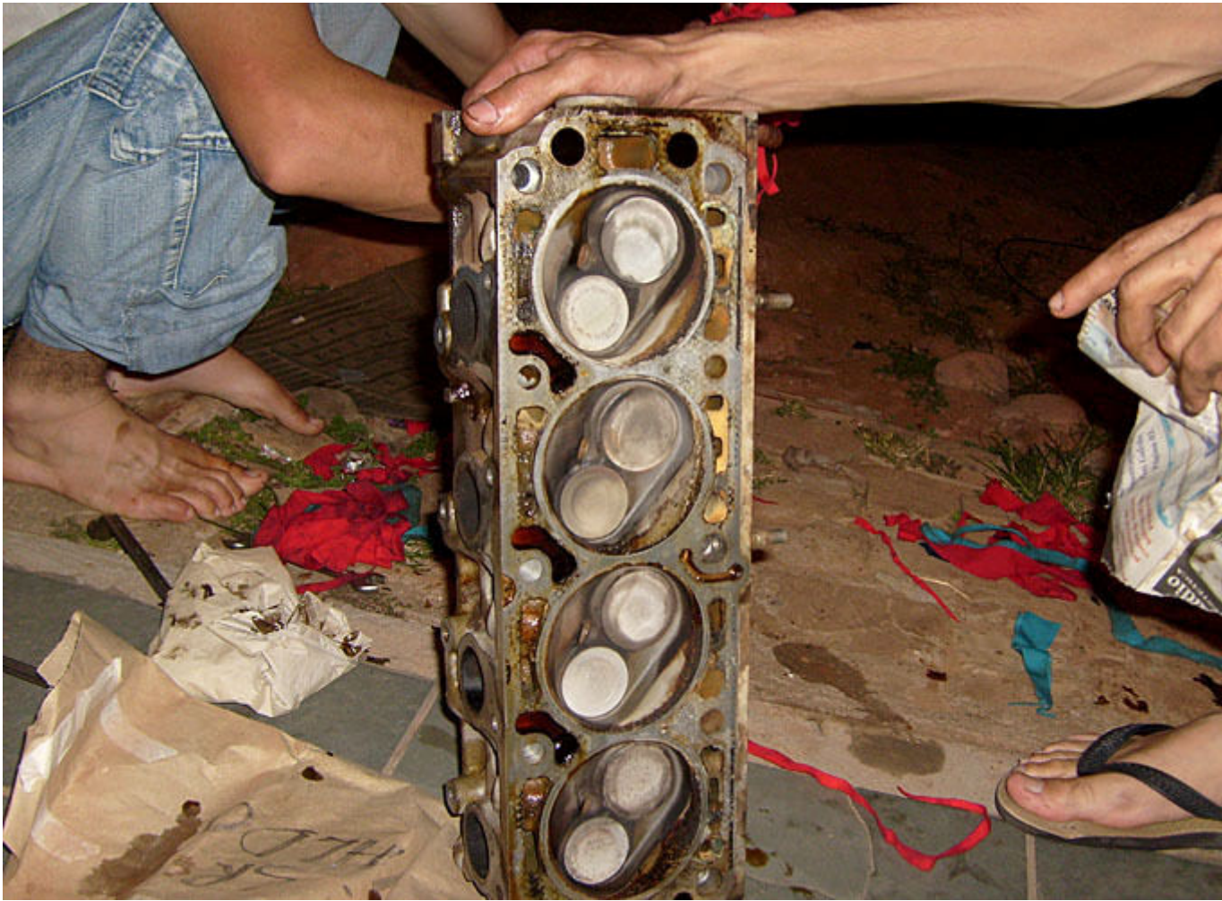
Válvula de admissão - carbonizada e com muito óleo na cabeça devido ao vedante danificado:
