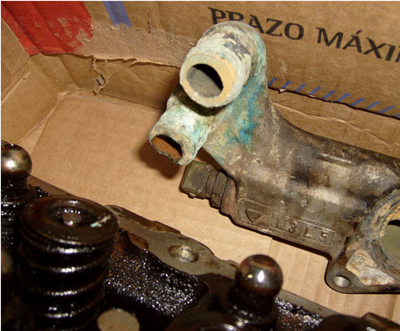
Estado das válvulas, e parte inferior do cabeçote (existe corrosão em uma das galerias de água):
