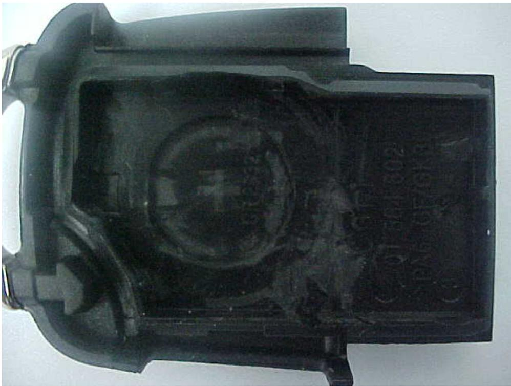
Usei Estilete e uma chave de fenda bem afiada para raspar o plastico.
