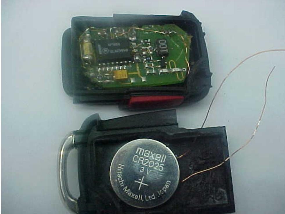
Eu coloquei fita isolante do lado positivo da pilha, que é este que esta aparecendo:
